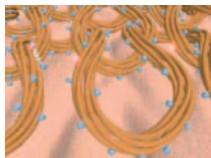
Mikrokapsle Skintex® na textilních vláknech
